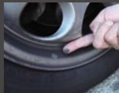
● 指でなぞると真っ黒な汚れが着く。これはパッドやローターが削れたもので、カスになって付着している。
