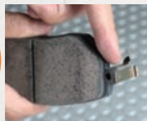
● パッドに付いている金属部分のパーツがセンサー。パッドが残り少なくなった時に、このセンサーがローターに接触。音を強制的に発生させることで、パッドの残量を知らせる。主に日本車に多い仕組み。
