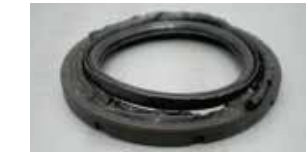
劣化して破れたダストブーツ Damaged Dust Boot
